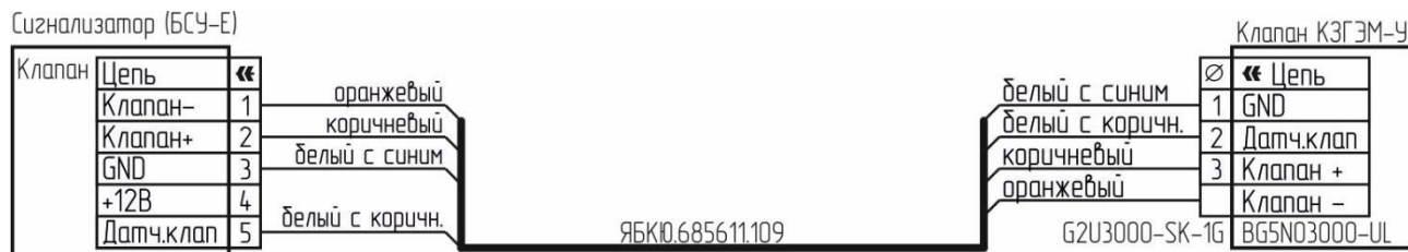
Рисунок VI.8 – Типовая схема подключения клапана КЗГЭМ-У с разъемом BG5N03000-UL
