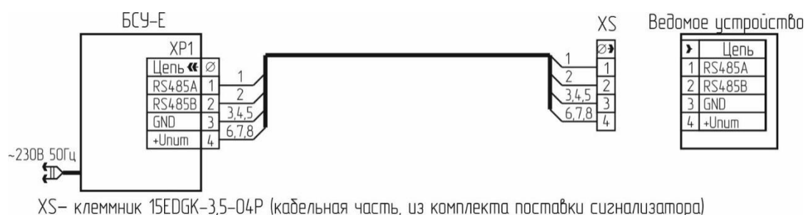
Рисунок А.1 – Схема соединений для программирования адресов.
