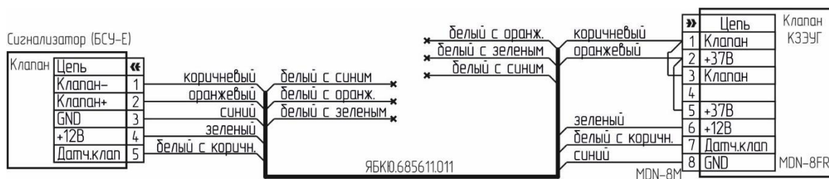
Рисунок VI.4 – Типовая схема подключения клапана КЗЭУГ с разъемом MDN-8FR
