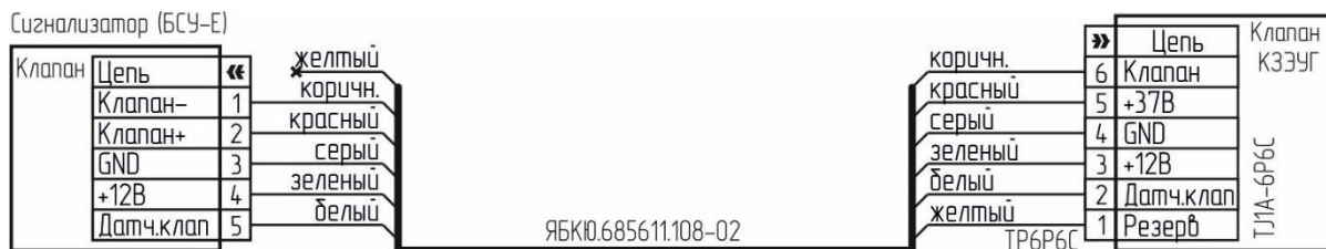
Рисунок VI.3 – Типовая схема подключения клапана КЗЭУГ с разъемом TJ1A-6P6C
