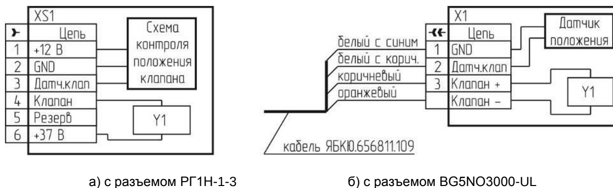
Рисунок VI.7 – Клапан КЗГЭМ-У. Схема электрическая принципиальная.
