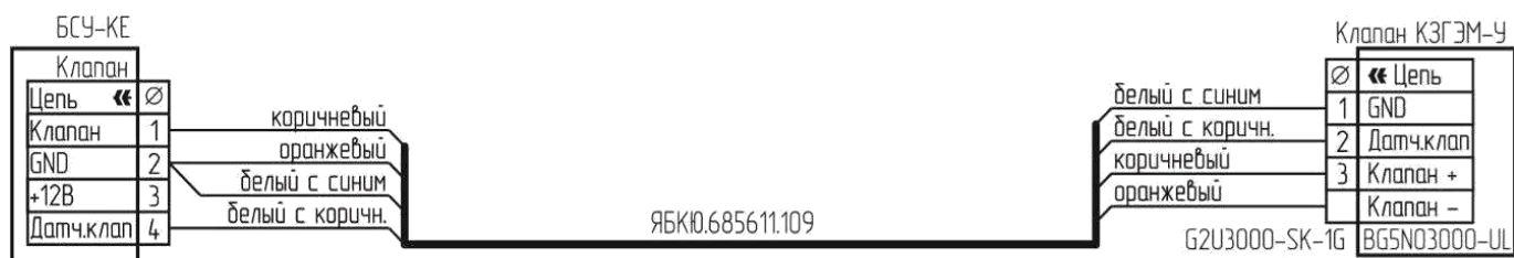
Рисунок А.1 – Типовая схема подключения клапана K3GEM-U с разъемом BG5N03000-UL
