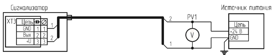
Рисунок Ж.1 – Схема включения сигнализатора СЗ-1ДЛВ-420К/24.
