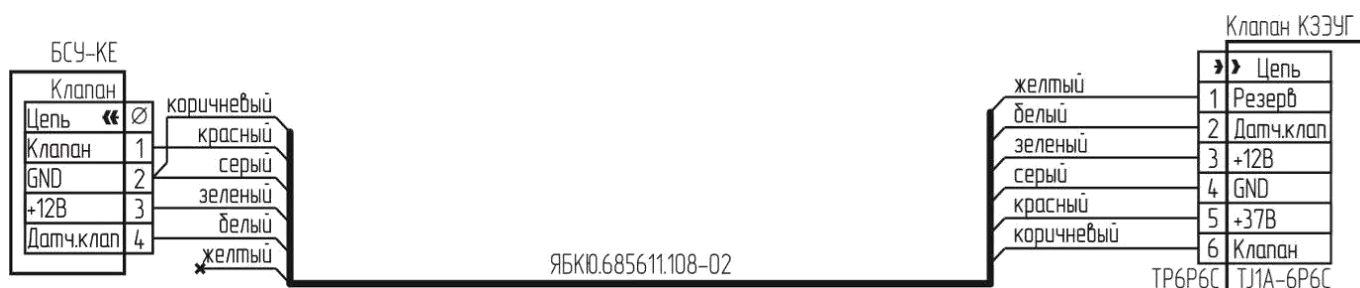
Рисунок А.2 – Типовая схема подключения клапана K3EUG с разъемом TJ1A-6P6C
