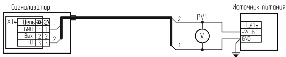
Рисунок Ж.2 – Схема включения сигнализатора СЗ-2ДВ-420/24.
