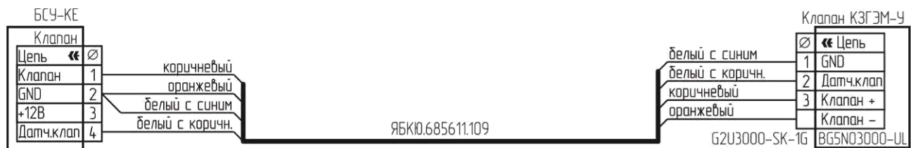
Рисунок Г.3 – Типовая схема подключения клапана К3ГЭМ-У с разъемом BG5N03000-UL
