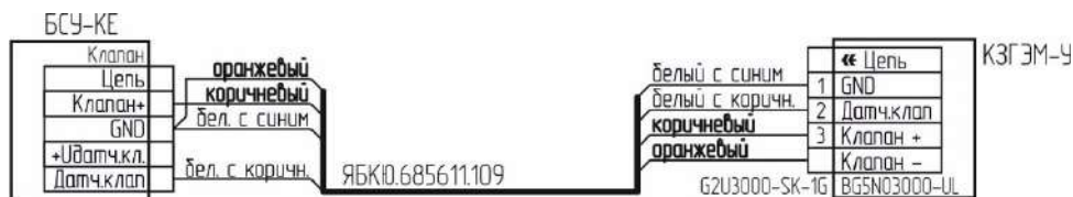
Рисунок Д.1 – Схема подключения клапана КЗЭУГ с разъемом BG5N03000-UL
