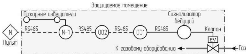
Рисунок 13 – Структура системы с RS485 и групповой защитой
