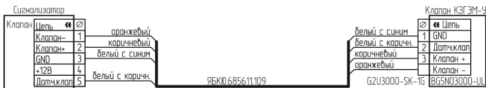
Рисунок В.1 – Схема подключения клапана КЗГЭМ-У с разъемом BG5NO3000-UL.
